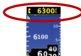
Figure 4 : Alerte visuelle si déviation de l'altitude cible
